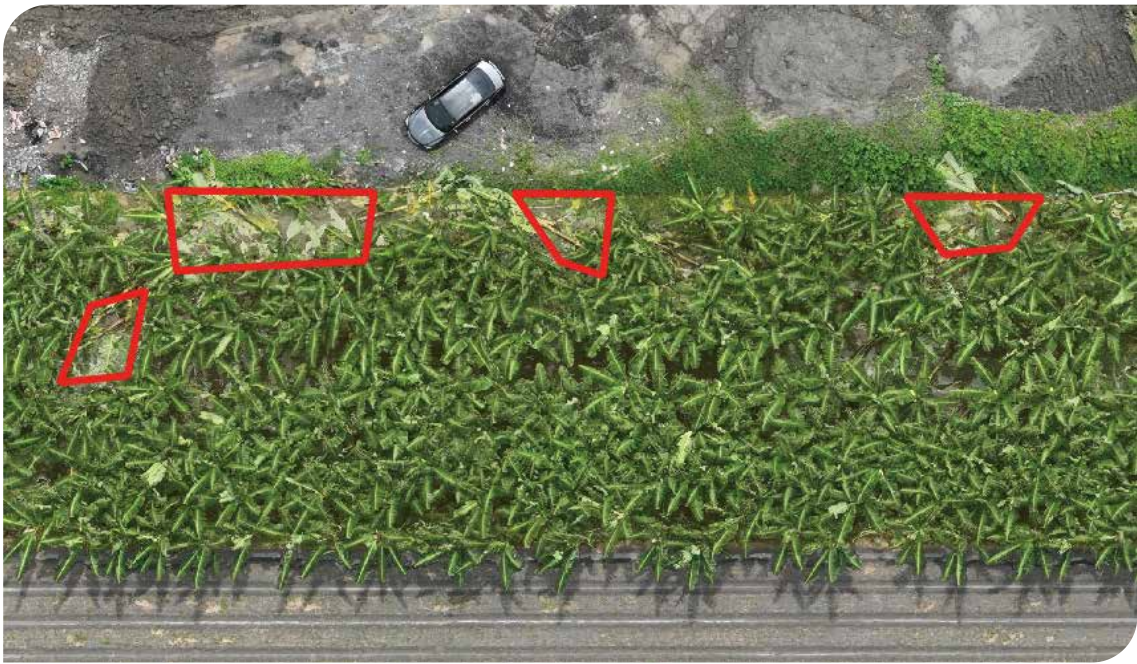
透過無人機產製正射影像圖並繪製香蕉植株倒伏範圍，紅框範圍為香蕉倒伏範圍。圖片來源：財團法人農業保險基金
