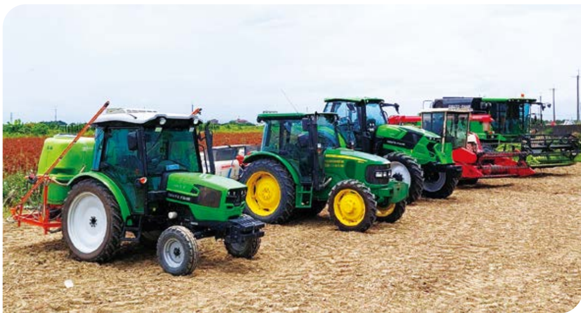
高粱機械化生產-曳引機（附掛真空播種機、翻土用迴轉犁、施藥桶）、聯合收穫機。 圖片來源：農委會農糧署
