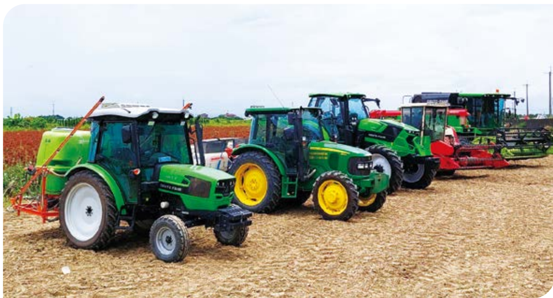
高粱機械化生產-曳引機（附掛真空播種機、翻土用迴轉犁、施藥桶）、聯合收穫機。
