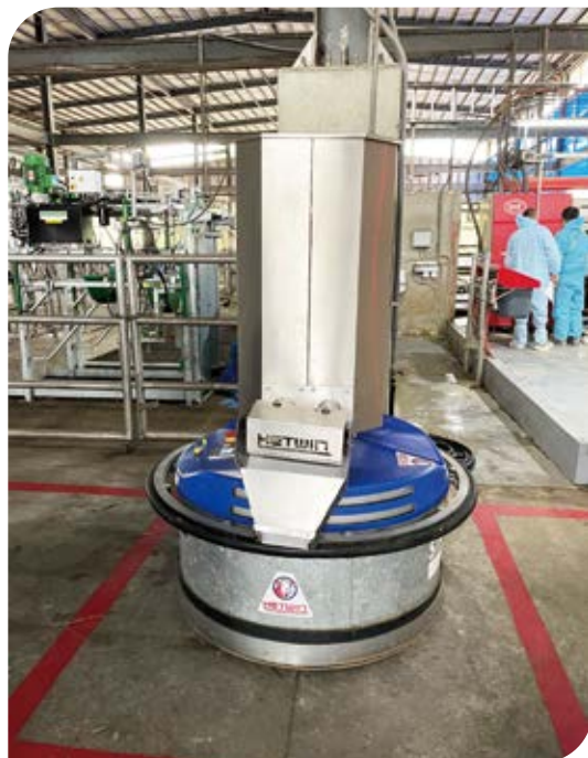
乳牛場自動化設備推料機器人。 圖片來源：農委會畜牧處
