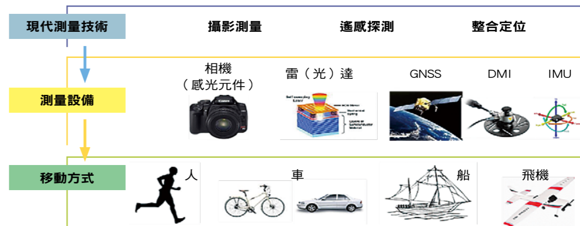
圖 1、現代測繪技術及搭載設備組合說明
