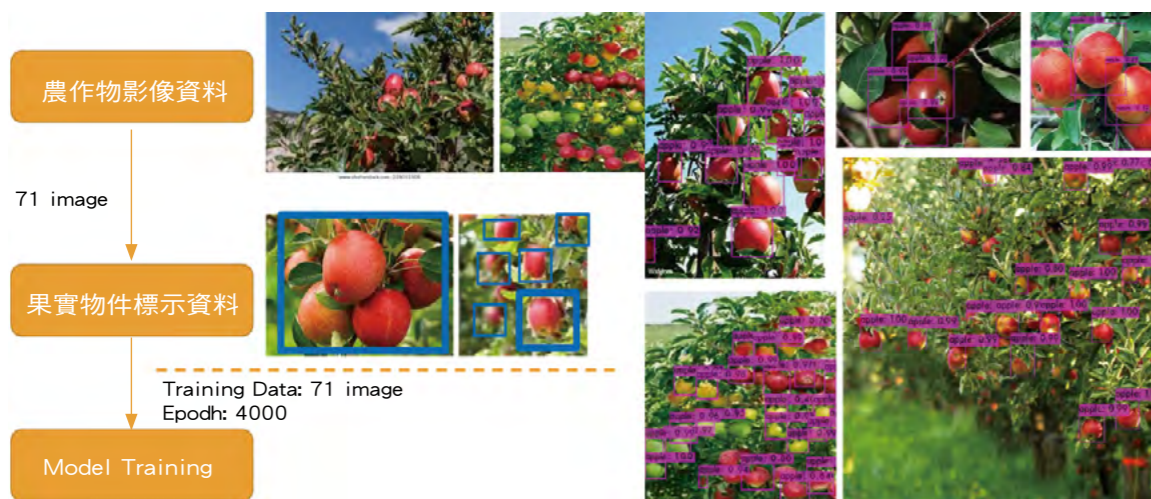
圖 16、農作物果實影像標示與學習模型辨識偵測成果
