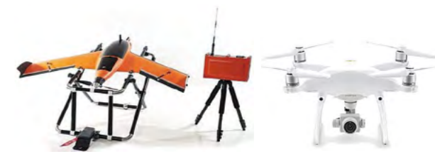
圖 1、無人機種類（左圖為定翼型，右圖為旋翼型）
